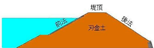
図2：ため池の断面図(均一型)
